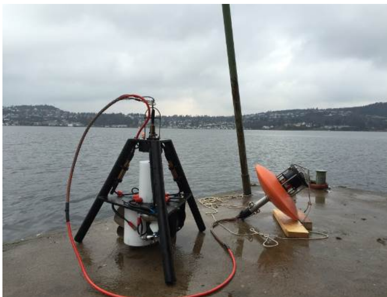
Figur 2.3 NILUS sensor node (til venstre) med akustisk modem (til høyre)
