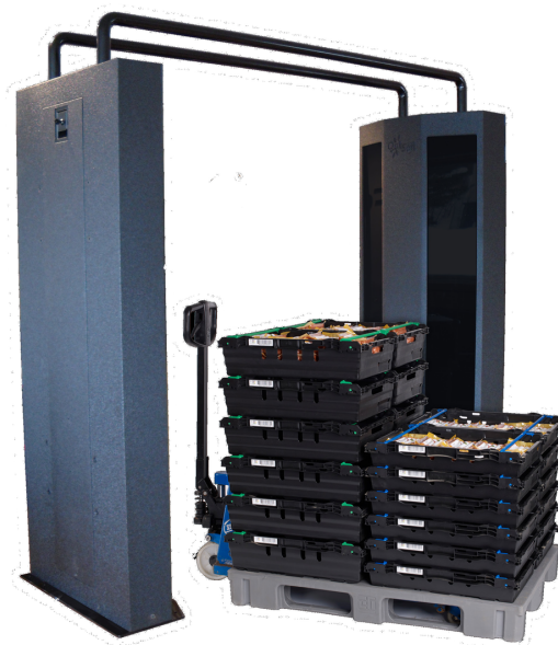
Figur 4.1 RFID leser benyttet av Nortura.
